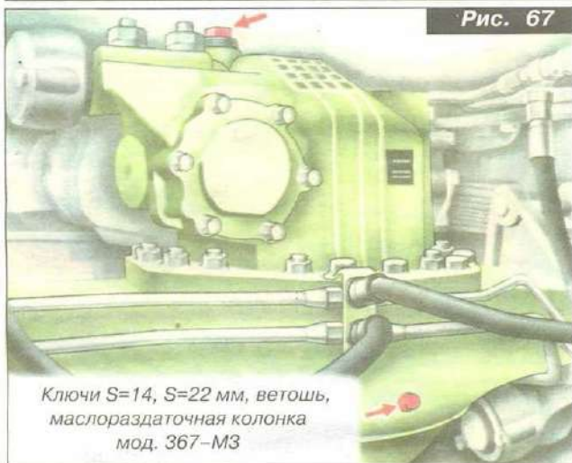
Рис. 67. Довести до нормы уровень масла в картерах ведущих мостов.
