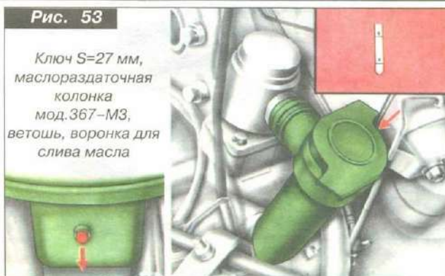
Рис. 53. Сменить масло в смазочной системе двигателя.
