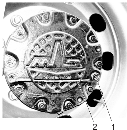
Рисунок 4.3.3 – Заправка маслом колесных передач ведущих мостов
